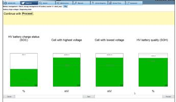
Aparte de ESI[tronic] 2.0 Online y un dispositivo KTS, no se necesita ningún otro hardware para leer el valor del SOH. Este paso de prueba se ofrecerá continuamente para otras marcas y modelos siempre y cuando esté soportado por el fabricante del vehículo.
