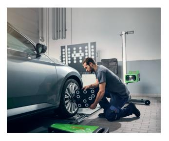
Questo funziona con l'aiuto di ESI [tronic] 2.0 e del KTS, nonché con strumenti specifici come DAS 800/1000 e SCT 415 o calibrazione su strada. La calibrazione su strada richiede un sistema di diagnostica mobile (ad esempio KTS 350).
